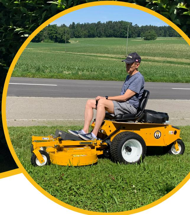
ermöglichen, sich frei nach oben und unten zu beugen, um das Abschälen der Grashaut und ungeschnittene Grasflächen zu minimieren. Dank des Torsionsflex-Trägerrahmens kann das Deck auch seitlich gebogen werden, sodass das Modell R unabhängig vom Gelände einen glatten Premium-Schnitt liefert. Das Modell R ist mit einem Mulchsatz ausgestattet, der installierbare Leitbleche und gezackte Mulchmesser umfasst.
