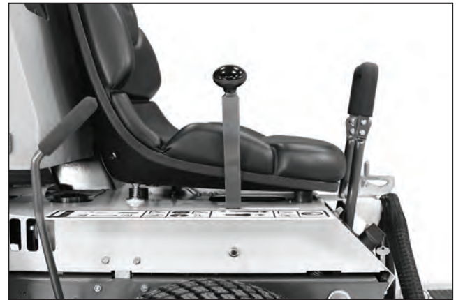
Korrekte Stellung des Geschwindigkeitsregelhebels (FSC) in Neutral-Park- Position
