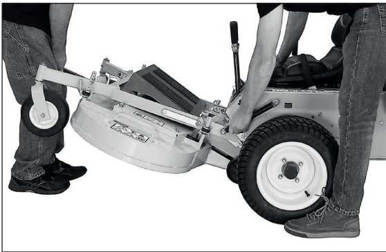
Montieren Sie die Gegengewichtsfeder am Trägerrahmen
