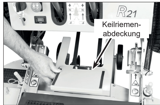
Heben Sie die Antriebsriemenabdeckung an, um den Riemen einzuführen
