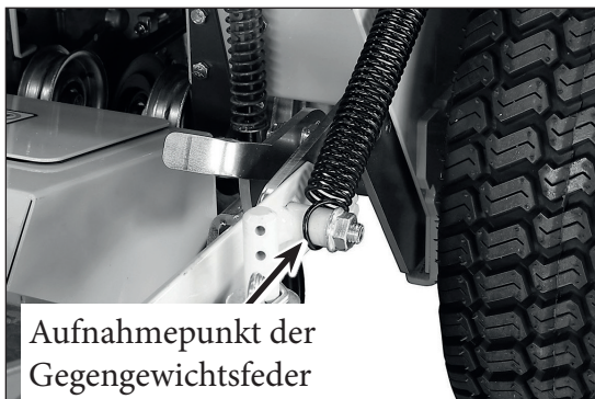
Aufnahmepunkt der Gegengewichtsfeder am Deck
