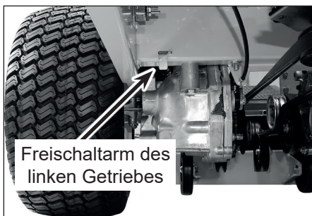
Freischaltarm des linken Getriebes (In der normalen Betriebsposition gezeigt)
