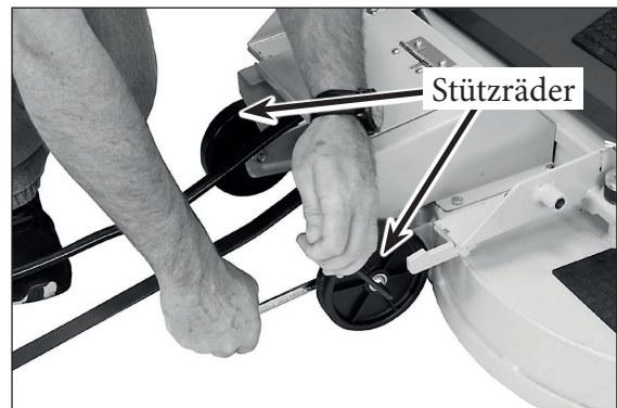
Stützradmontage des Mähdecks
