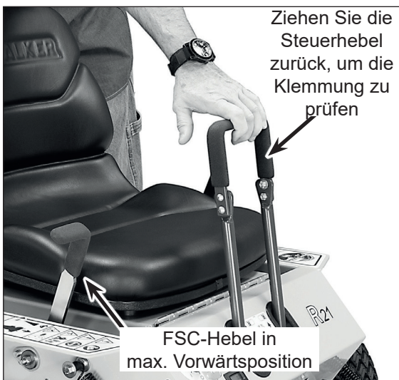
Überprüfung der FSC-Klemmfunktion
