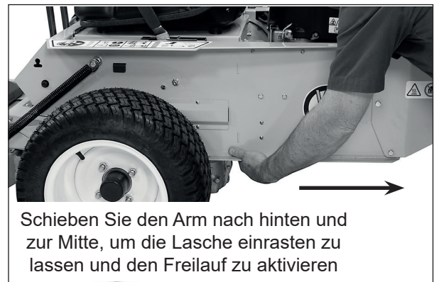
Freischaltung der Getriebe (linke Seite abgebildet)
