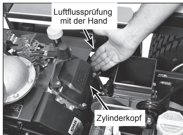
Motorkühlungs-Lufterlasssieb und Wartungsklappen des Kohlermotors.
