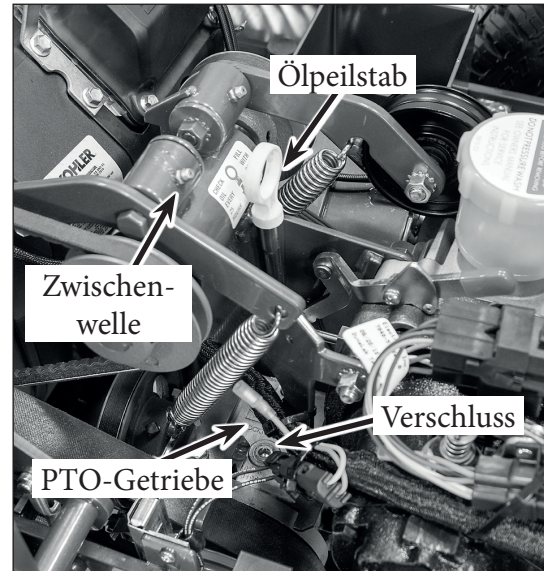
Position des Ölpeilstabes am PTO Getriebe
